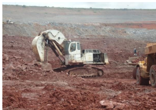
Fig 5. a).- Importância da escarificação do minério. b). Fácil carregamento quando o material está previamente desmiuçado.
