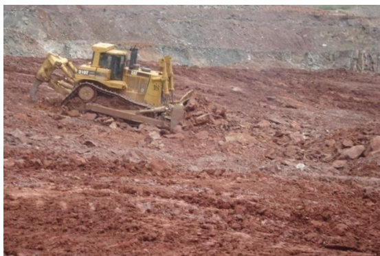
Fig 5. a).- Importância da escarificação do minério. b). Fácil carregamento quando o material está previamente desmiuçado.
